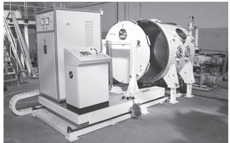
ума. Система водяного охлаждения выполнена с датчиками контроля воды и превышения температуры, фильтрами механической и химической очистки воды. Информация для контроля и оперативного реагирования от датчиков в реальном масштабе времени передается в промышленный контроллер.
